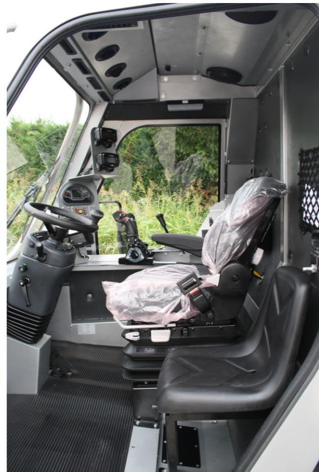
» Cabina con struttura in acciaio inox, spaziosa e con ottima visibilità.
