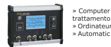
» Computer per controllo automatico delle dosi di trattamento.
