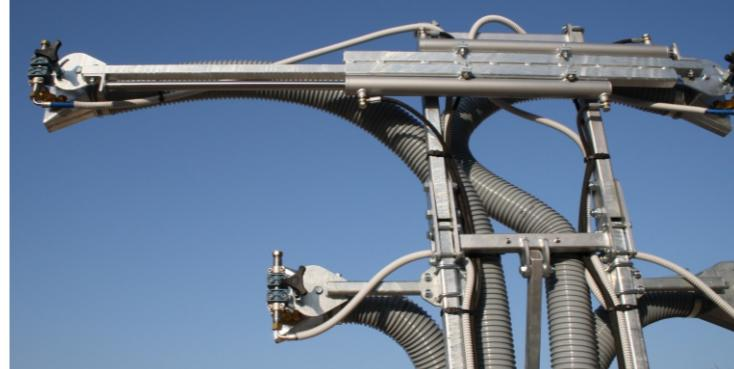
» Disponibile anche la regolazione idraulica delle bocchette, per adattarsi velocemente a diverse forme di vegetazione.
